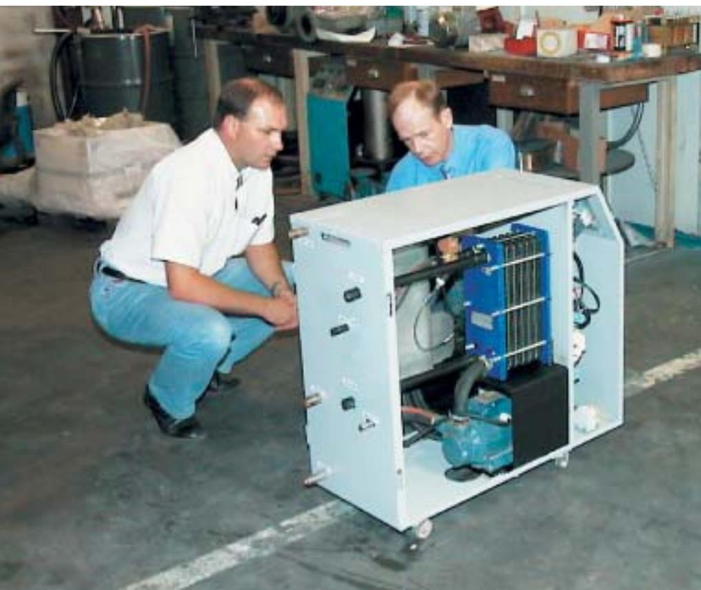
Г-н М. Шредер, генеральный директор компании Parmilleux: «Размер теплообменников Platelec позволяет создавать компактные терморегуляторы, которые можно устанавливать в непосредственной близости от прессов и пресс-форм».
