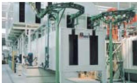
Компания Imel использует в своих установках пластинчатые теплообменники Alfa Laval в качестве нагревателей ванн для химической обработки. Турбулентность потока на поверхности пластин обеспечивает непрерывное перемешивание рабочих сред и препятствует загрязнению каналов.
