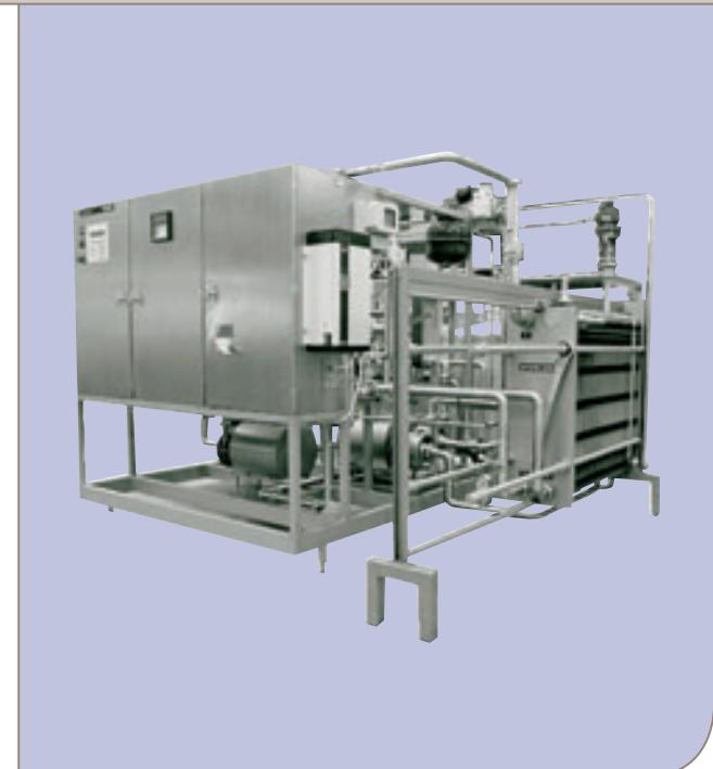
производительность установки FLEXITHERM™. При увеличении производительности разливочной машины уровень в баке снизится и, соответственно, увеличится производительность установки FLEXITHERM™.
