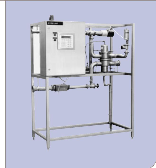
Коэффициент смешивания продуктов или, если требуется, полный объем партии продукта, задается оператором. После этого процесс выполняется автоматически до выдачи команды остановки при выработке заданного объема продукта.
