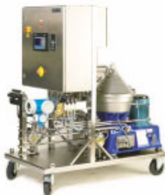
Передвижная лабораторная сепарационная установка для небольших ферментационных процессов.
