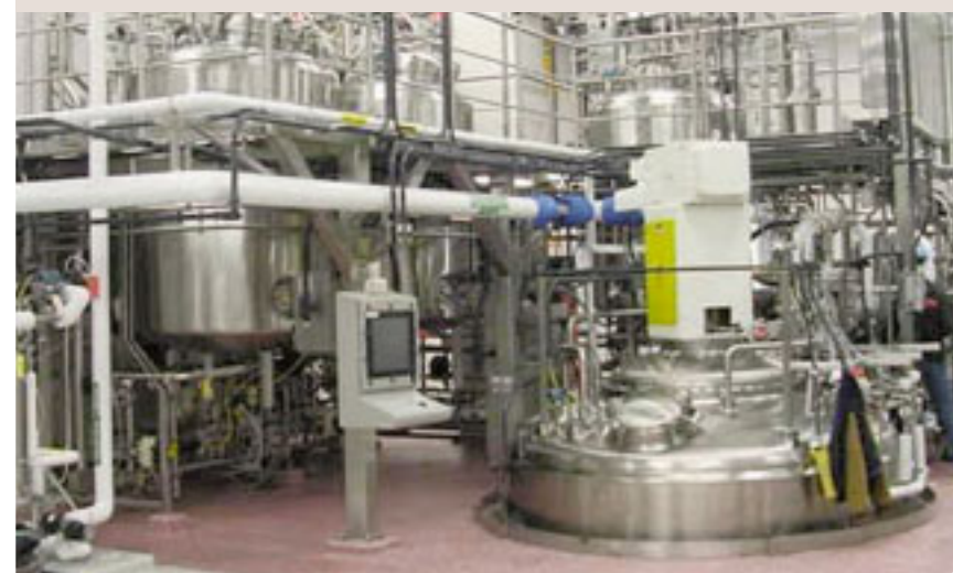
Биореактор на 20000 литров установки фирмы Lonza Biologics
